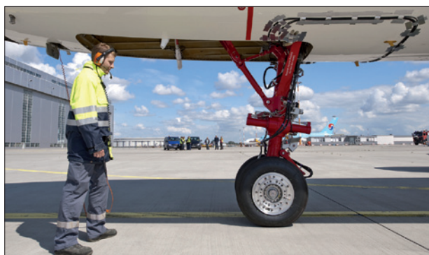
Obr. 1. Přídové kolo podvozku letadla Airbus A320 upravené pro elektrický pohon (foto: Airbus)
