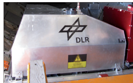
Obr. 2. Jednotka palivových článků vestavěná do výzkumného letadla Airbus A320 ATRA (foto: DLR)
