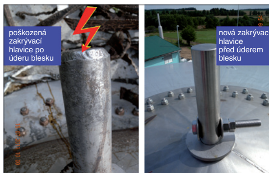
Obr. 4. Porovnání horních dílů fermentoru po úderu blesku a před ním
