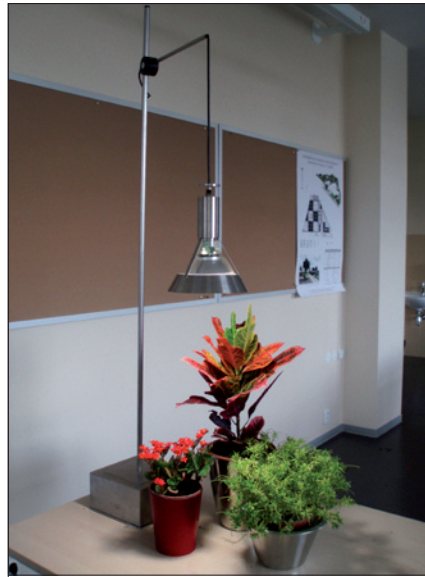
světelný zdroj – reflektorová kompaktní zářivka Megaman BR 0623 PAR 30/840, 23 W, I_0 = 339 \text{ cd} , úhel poloviční svítivosti 110^\circ , k_{\text{mol}} = 12,2 \mu\text{mol}\cdot\text{s}^{-1}\cdot\text{m}^{-2}/\text{klx} , život 10 000 h (2 až 4 roky)
