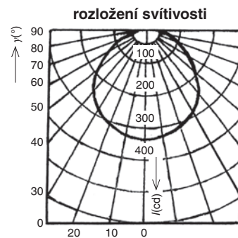
světelný zdroj – reflektorová kompaktní zářivka Megaman BR 0623 PAR 30/840, 23 W, I_0 = 339 \text{ cd} , úhel poloviční svítivosti 110^\circ , k_{\text{mol}} = 12,2 \mu\text{mol}\cdot\text{s}^{-1}\cdot\text{m}^{-2}/\text{klx} , život 10 000 h (2 až 4 roky)
