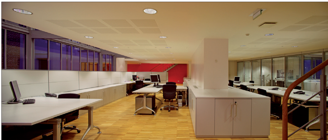
Obr. 2. Použití přímých svítidel (downlight) k osvětlení kancelářského prostoru
