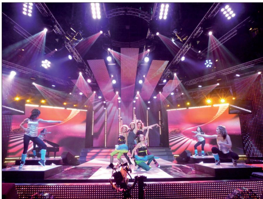
Obr. 2. Použitie LEDvideostien na podujatí Eurovision Song Contest Slovakia 2010, centrálna: spodok – modul 40mm rozlíšenie – GRAFIKA, centrálna stĺpy – systém Schnick-Schack 50mm rozlíšenie – GRAFIKA pod stĺpmi: schody – modul 10 mm – zobrazovacia stena / postranné obrazovky – zobrazovacie plochy 6mm rozlíšenie – zobrazovacia stena
