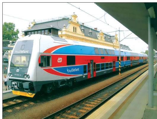
Obr. 3. Elektrická jednotka řady 471 (City Elephant) pro stejnosměrnou proudovou soustavu 3 kV
