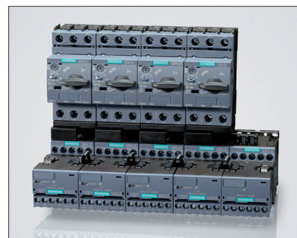
Obr. 4. Moduly doplňkových funkcí zjednodušují zapojení řídicích obvodů spouštěčů reverzačních a typu hvězda-trojúhelník včetně elektrického blokování a časového zpoždění, popř. komunikačního rozhraní AS-Interface nebo IO-link
