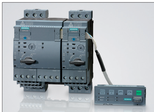
Obr. 6. Kompaktní vývody Sirius 3RA6 s rozhraním AS-Interface/IO-link zjednodušují připojení k řídicímu systému stroje: diagnostické informace jsou dostupné centrálně na systémech pro ovládání a vizualizaci, dále umožňují lokální ruční ovládání až čtyř spotřebičů jedním ovládacím modulem
