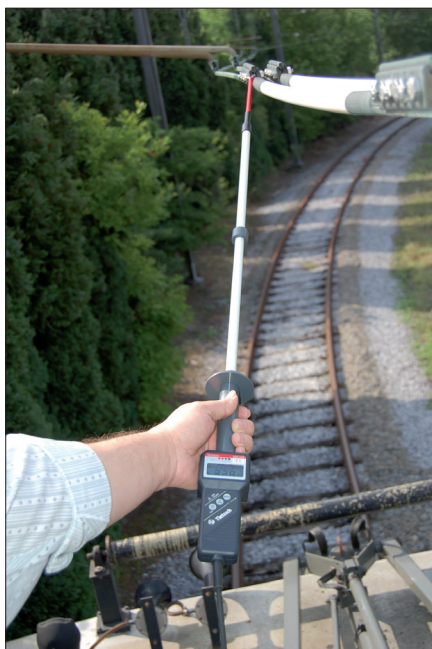
Obr. 1. Měření se zkoušečkou vybavenou nástavcem
