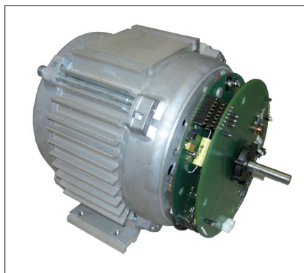
Obr. 6. Integrace elektronické jednotky do motoru BLDC
