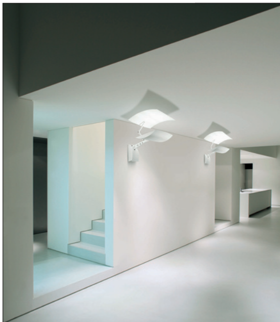
Obr. 2. Oyster, Luxit, 1× 250W halogenidová výbojka, šířka 650 mm, výška 900 mm, hloubka 740 mm, 35 244 Kč bez DPH
