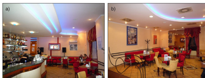
Obr. 3. Příklad osvětlení cukrárny a restaurace a) příjemné prostředí cukrárny s restaurací, b) osvětlenost stolů 145 až 259 lx
