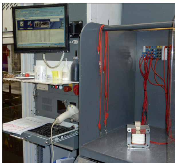
Obr. 9. Závěrečné ověření parametrů transformátoru
