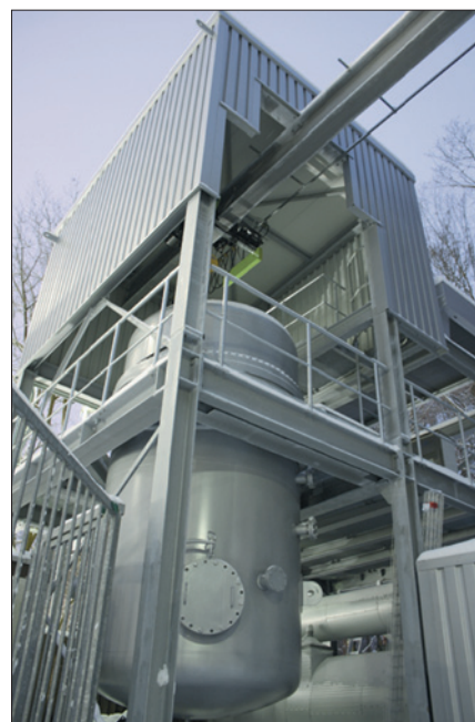
Obr. 4. Zařízení pro testování vysokoteplotních akumulátorů tepla v Ústavu pro technickou termodynamiku DLR ve Stuttgartu (foto: DLR)
