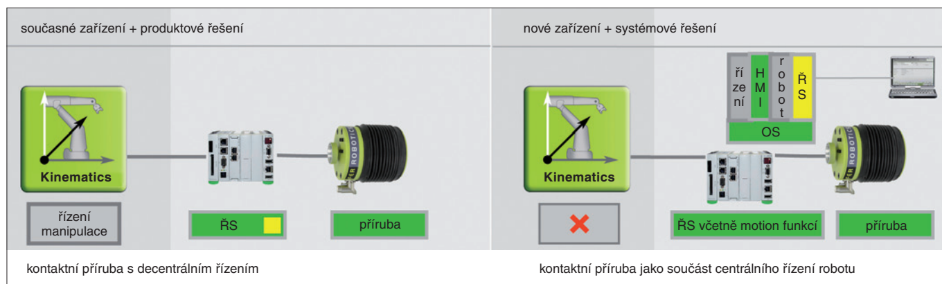
Obr. 3. Začlenění aktivní kontaktní příruby do robotického systému
