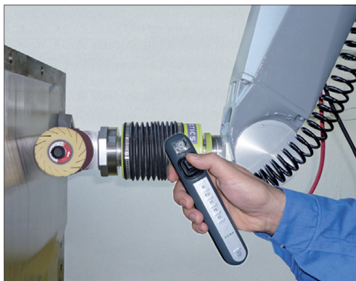
Obr. 2. Příruba namontovaná na konci robotického ramene
