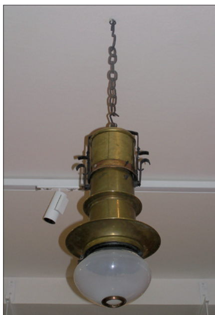
Obr. 6. Plamencová oblouková lampa, patent Očenášek, přelom 19. a 20. století, výrobce neznámý
