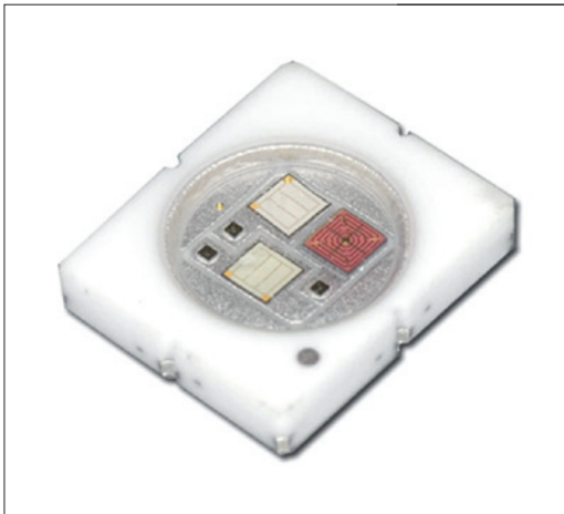
Obr. 1. Detailní zobrazení RGB LED se třemi barevnými čipy
