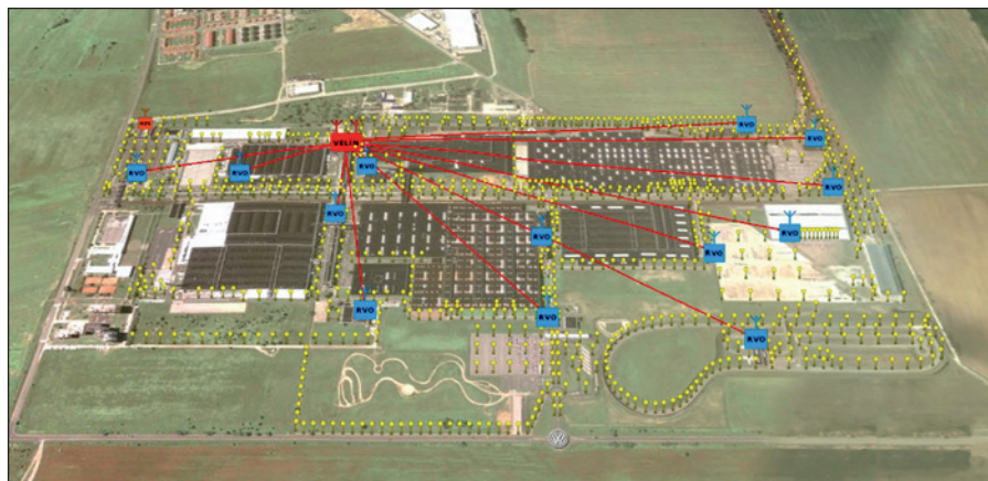
Obr. 3. Umiestnenie svietidiel, rozvádzačov a veľína
