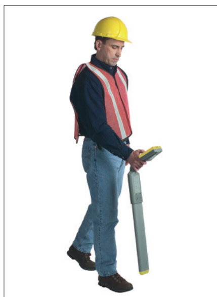
Obr. 1. Trasování kabelového metalického vedení přijímačem typu 8879-RF/CP (vysílač je připojen na kabelové vedení na jiném místě)
