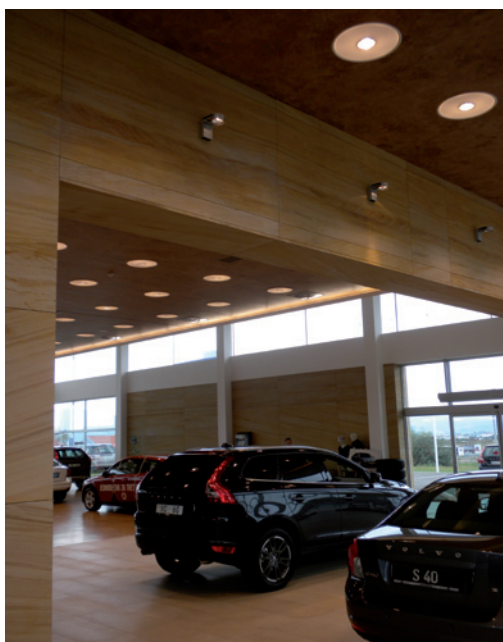
Obr. 4. Na preklade sú osadené spoty Waco Invader QR-LP 111/100 W pre akcentové osvetlenie modelov
