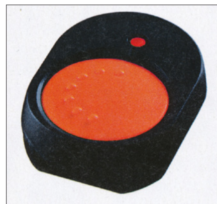
Obr. 6. Rychlé a diskrétní poplachové zařízení proti přepadení s přenosným vysílačem přepadení
