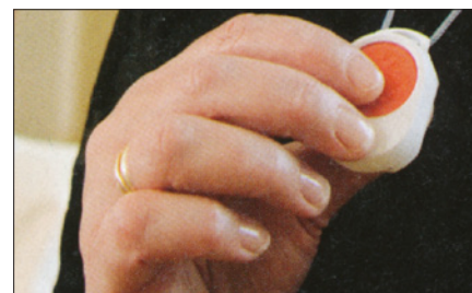
Obr. 7. Bezdrátový tísňový vysílač ve velikosti náramkových hodinek vážící 14 g se vejde do každé kapsy – díky krytí IP65 se s ním lze i sprchovat
