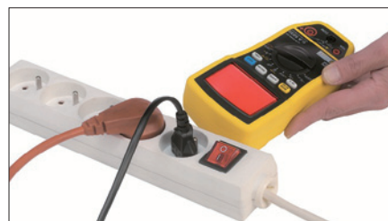
Obr. 2. C.A 5233 v akci; červená plocha displeje indikuje bezdotykově zjištěnou přítomnost elektrického napětí
