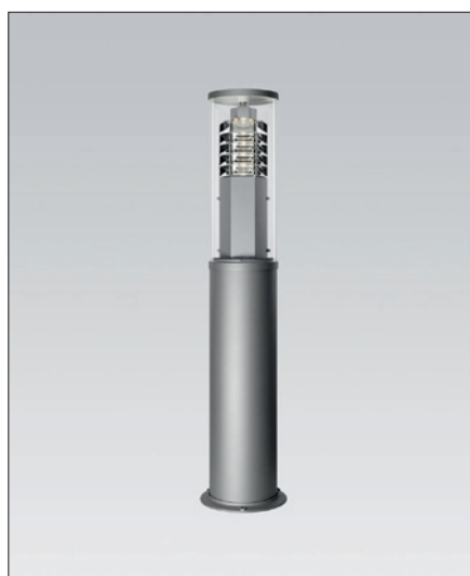
Obr. 6. Svítidlo Siteco City light LED - do horního poloprostoru vyzařuje necelých 5% světelného toku; podle Nařízení [2] vyhovuje z environmentálního hlediska, vyhovělo by i tehdy, kdyby mělo více než šestkrát větší světelný tok než nyní (1 850 lm)
