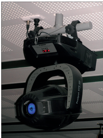
Obr. 5. Inteligentní světlomet Coemar ProSpot 575 MB s halogenidovou výbojkou MSR
