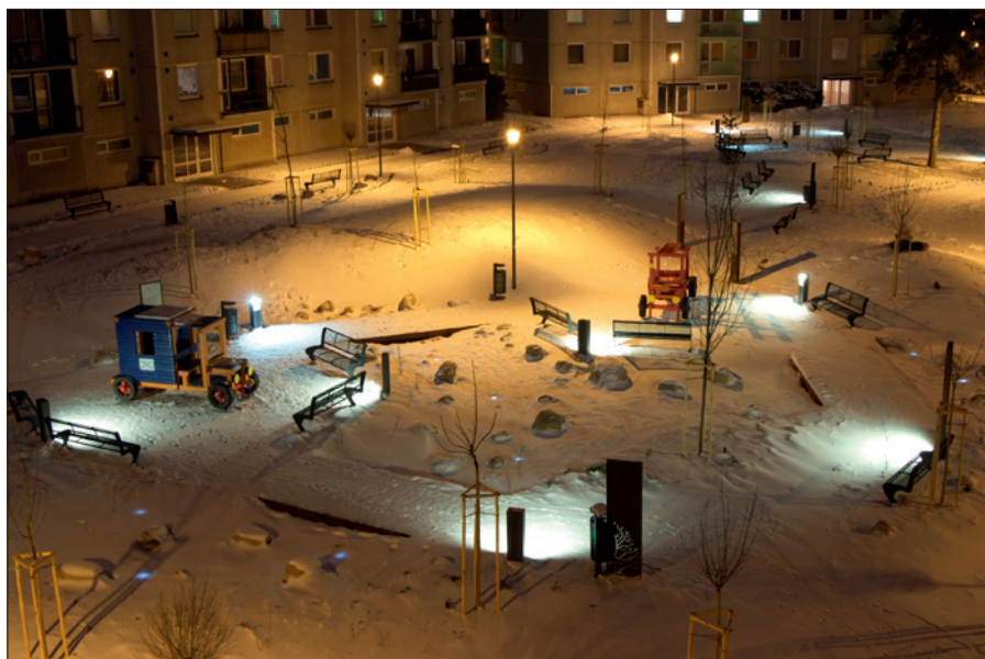
Obr. 2. Celkový pohled na park v zimě; pod sněhem jsou vidět svítidla LYN 4 umístěná v řečišti; díky nízké povrchové teplotě sněh zcela neroztaje a funguje jako zajímavý druh přírodního difuzoru
