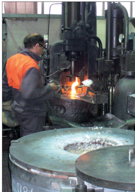
Obr. 20. Lití hliníku pod tlakem
