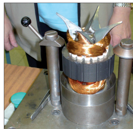
Obr. 26. Tvarování čel vinutí
