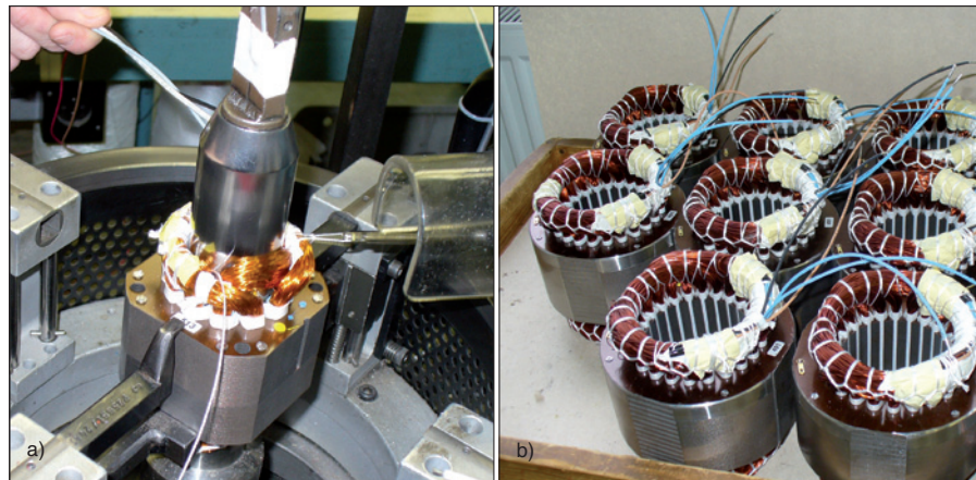
Obr. 27. Obšívání čel vinutí – a) obšívací stroj, b) obšité hlavy vinutí
