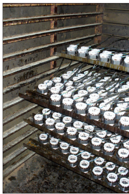
Obr. 29. Impregnované statory připravené k sušení v peci
