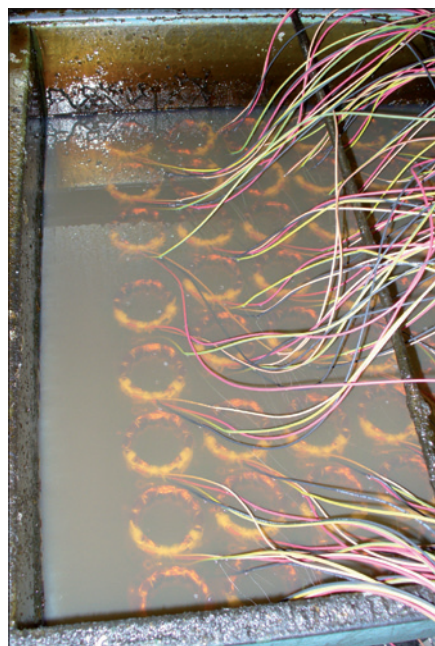
Obr. 28. Navinuté pakety namočené v impregnantu
