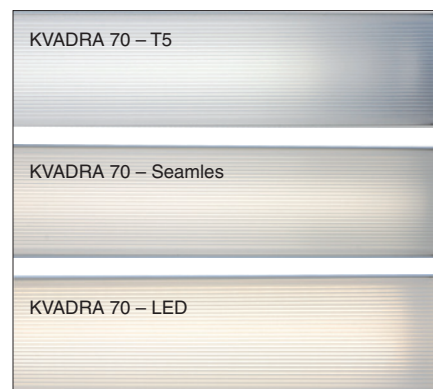
Obr. 9. Srovnání jasů u satinovaného krytu svítidla KVADRA 70 se zářivkou T5, SEAMLESS a LED
