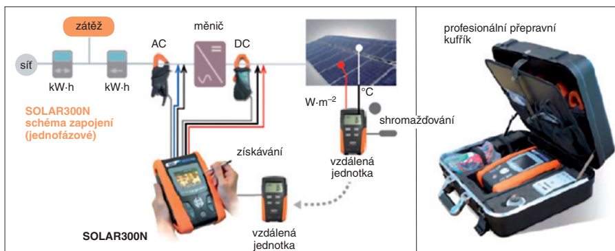
Obr. 2. Příklad zapojení měřicího přístroje při kontrole jednofázově připojeného měniče
