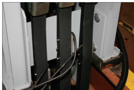
Obr. 3. Detail nosných pryžových pásek a tenzometrických čidel zatížení kabiny
