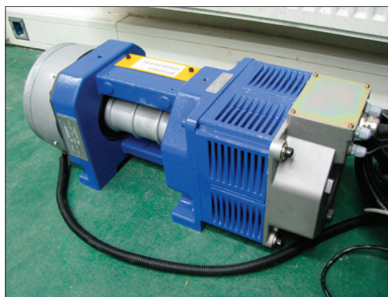
Obr. 2. Pomaluběžný synchronní výtahový motor o výkonu 3 kW s mechanickou brzdou a inkrementálním enkodérem
