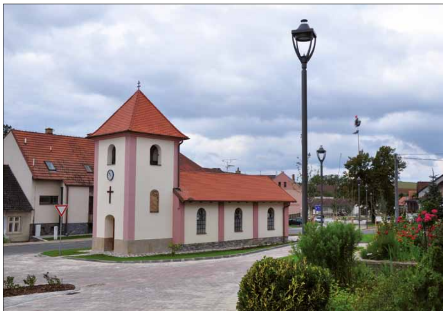
Obr. 3. Osvětlení historického centra obce Sívce (stožár SBD 4,5 žárově pozinkovaný + RAL, svítidlo Legend CLS 1x 70 W)
