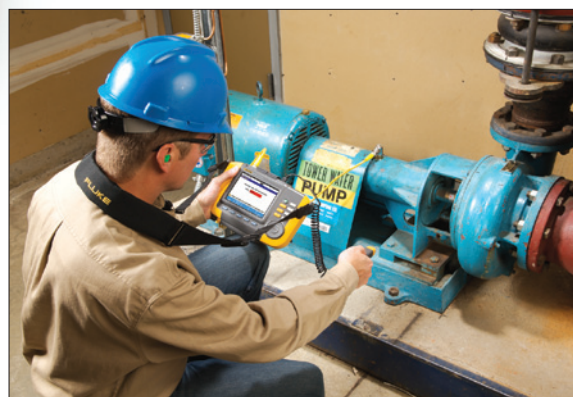
Práce v terénu s testerem vibrací Fluke 810
