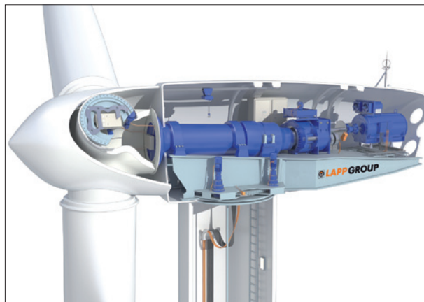
Obr. 3. Gondola větrné elektrárny v řezu
