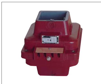
Obr. 4. Měřicí transformátor proudu ABB typ BB 103 pro vnitřní prostředí, dvoujádrový, jmenovitý převod 4 000/5/5 A, izolační napětí 12 kV, třída přesnosti 0,5/5P
