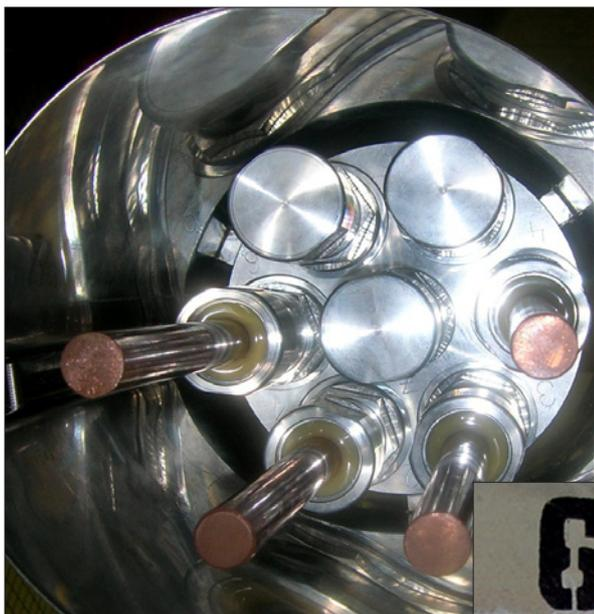
tlakovými a tepelnými vlivy. HKP z Kabelovny Kabex<sup>®</sup> těsní prostupy kabelových vedení tlakovými předěly tlakově odolnými a plynotěsnými stavebními konstrukcemi. Zajišťují separaci prostorů i při mimořádných vlivech (přetlaky, zatopení, výbuch apod.) i v radiačně zatížených objektech.
