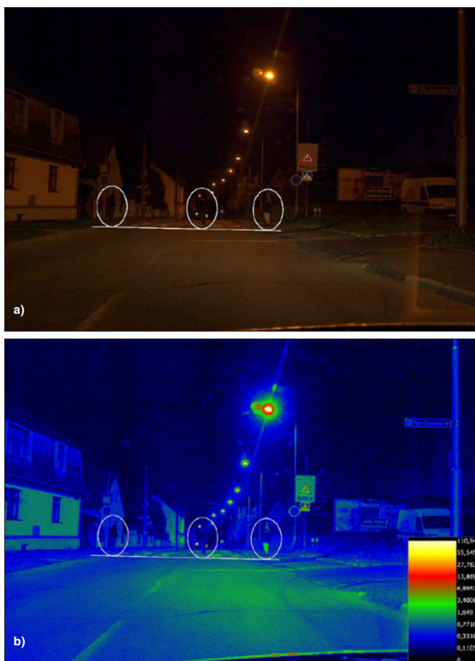
Obr. 1. Příklad posouzení viditelnosti chodců na neosvětleném přechodu pro chodce v Broumovské ul. v Liberci – přechod u školy a) fotografie pořízena ze stojícího vozidla 30 m před přechodem s rozsvícenými tlumenými světlými vozidla – elipsa vyznačuje polohu figuranta na přechodu b) analýza této fotografie v programu LumiDISP, která nám ukazuje závojevový jas na čelním skle vozidla včetně nedokonalé viditelnosti figurantů na přechodu z vozidla
