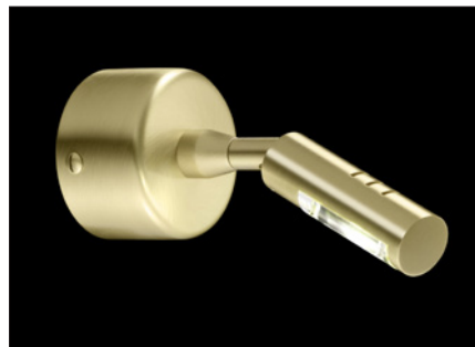
Obr. 3. Nástěnné LED svítidlo výrobce: Knapstein, Německo obj. číslo: 21.809.03 provedení: matná mosaz rozměry: hloubka 175cm krytí: IP20 světelný zdroj: LED, 1x 5 W, 4 100 K MOC: 4 280 Kč
