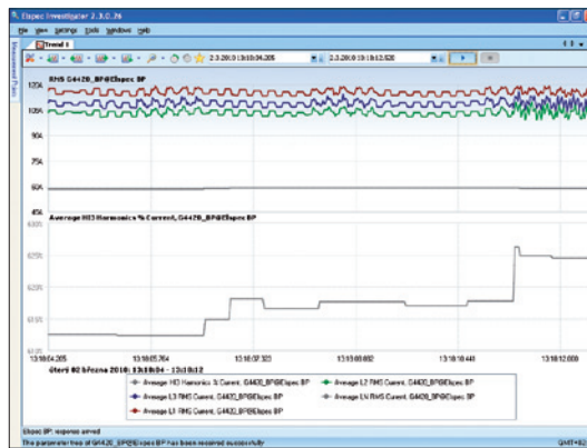
Obr. 7. Proud nulovým vodičem má dominantní 3. harmonickou složku
