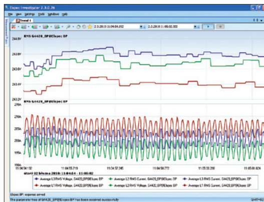
Obr. 6. Proud i v ustáleném stavu kmitá s frekvencí ca 5 Hz
