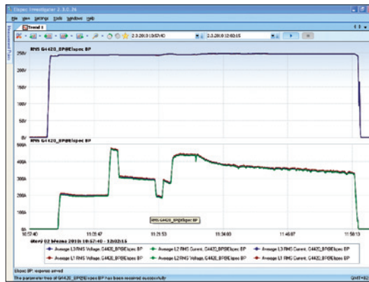
Obr. 4. Záznam napětí a proudů při spuštění a zastavení generátoru
