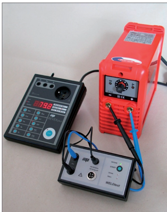
Obr. 12. Měření napětí svařovacího obvodu
