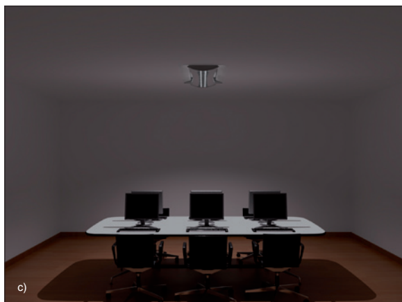
Obr. 3. Použitie Modulu eYe s rôznymi krivkami svietivosti v priestore, a) úzka, b) pološiroká, c) široká
