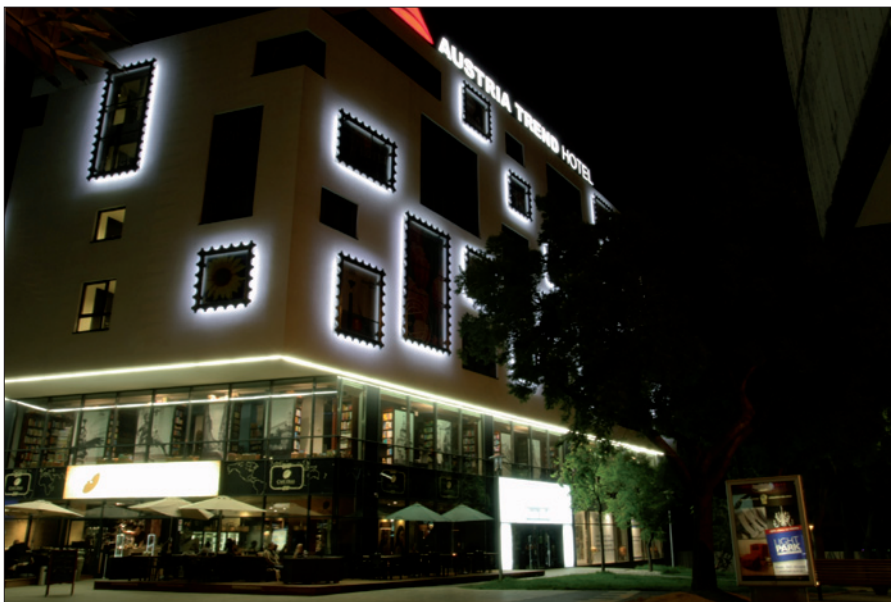
Obr. 1. Stmievateľný svetelný pás osvetľuje nielen hotel, ale aj chodník a časť pešej zóny; diódy LED zase nasvetľujú „poštové známky“ a vytvárajú správnu atmosféru
