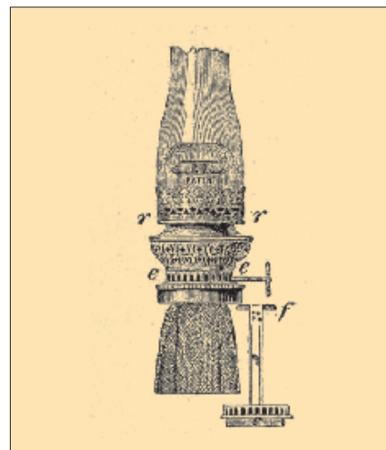
Obr. 7. Německý patentní hořák lampy na solární olej; vpravo vzduchová tyčinka, která byla zasunuta uprostřed hořáku shora, firma Schuster & Baer, Berlín, asi rok 1875
