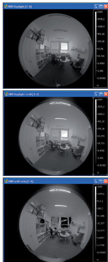
Obr. 5. Získání jasové mapy umělého osvětlení, shora: jasová mapa pro denní osvětlení, sdružené osvětlení, jen umělé osvětlení
