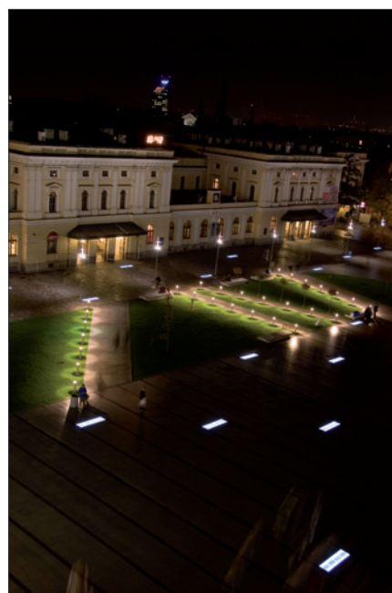
Obr. 7. Svítidlo Terralux LED – rozměry: 500 x 500 x 34 mm (hmotnost 18 kg) nebo 250 x 500 x 34 mm (hmotnost 34,9 kg); barevné provedení: bílá, modrá, zelená, žlutá, červená, možnost RGB; krytí IP54, 3D izolace, 6 W, 24 V DC
