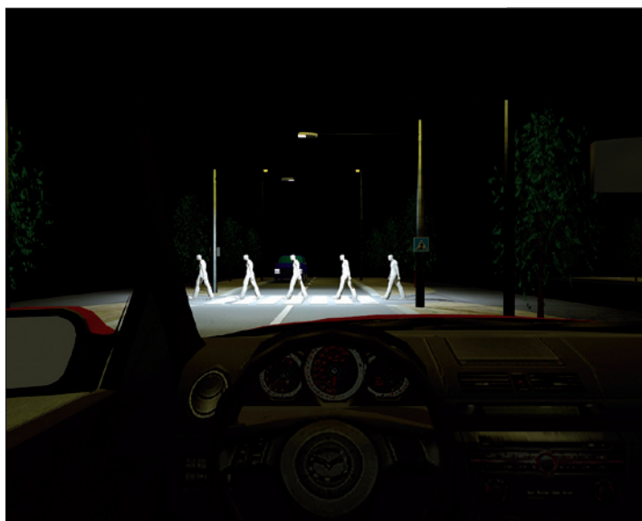
Obr. 2. Týž přechod s volbou pozitivního kontrastu; chodci jsou dostatečně kontrastní, je osvětlen i nástupní a výstupní prostor – přechod je mnohem bezpečnější než přechod na obr. 1
