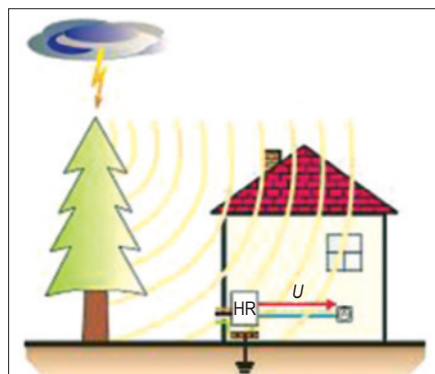
Obr. 1. Úder v blízkosti inženýrské sítě připojené stavbě ke stavbě bez hromosvodu
