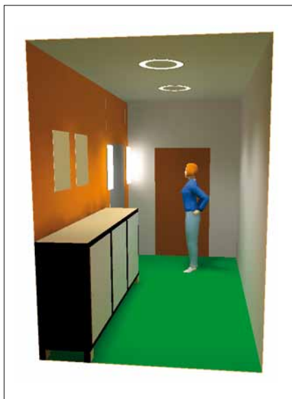
Obr. 1. V předsíni zajišťují celkové osvětlení stropní svítidla; u zrcadla další svítidla umožní zkontrolovat vzhled osoby na odchodu
