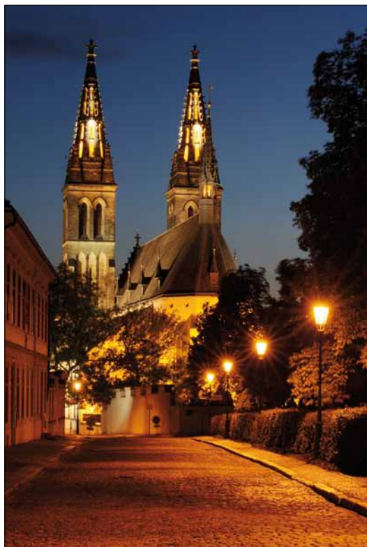
Obr. 1. Kostel na Vyšehradě Kombinace dálkového osvětlení věží kostela (plošné svícení) s bodovým zdůrazněním horní části věží a rozdílnou teplotou chromatičnosti svítidel uvnitř věže kostela a hlavního vchodu; závěr kostela nasvícen asymetrickými světly z malé vzdálenosti od stěn; použité světlo Artechnic-Schröder Terra, Olympia, Neos 2, Neos 3, Focal, Art004; instalované světelné zdroje Philips
