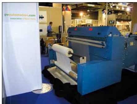
Obr. 12. Řezačka EVA fólie na definované rozměry (vlevo) a zařízení na zahřátí PV panelu nad teplotu tání EVA fólie (vpravo)
