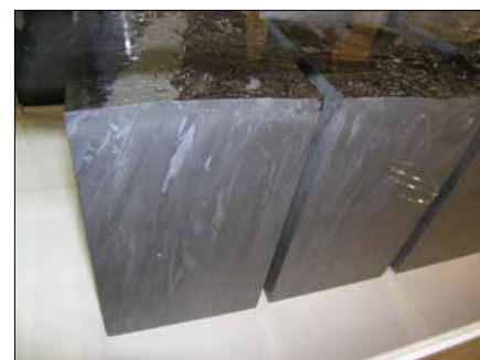
Obr. 3. Polykrystalické ingoty křemíku
