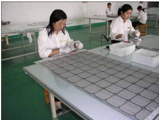
Obr. 10. Montáž PV panelů v Jiaxingu (Čína)
