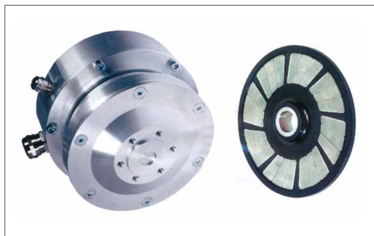
Obr. 1. Servomotor s diskových rotorem a axiální vzduchovou mezerou firmy Framo Morat (vlevo) a rotor s nalepenými segmenty permanentních magnetů (vpravo)
