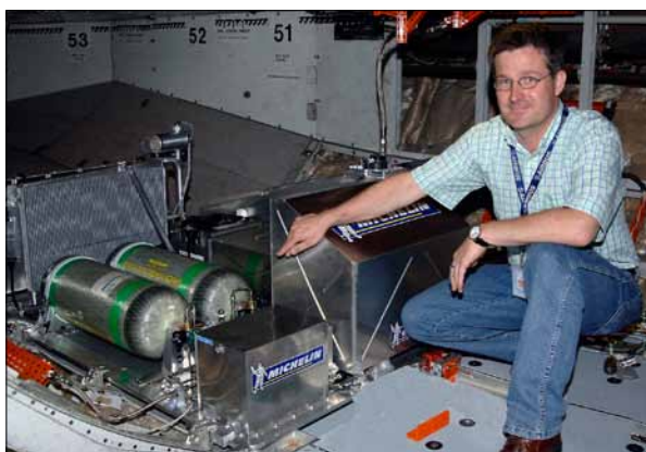
Obr. 2. Palivové články v letadle Airbus 320 ATRA (Zdroj: DLR)
