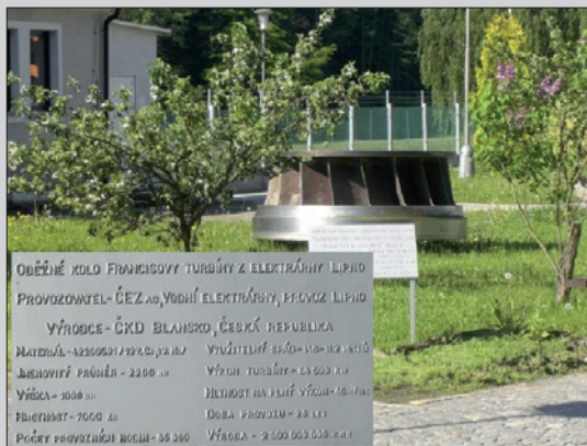
Obr. 5b. Vysloužilá Francisova turbína v areálu elektrárny Lipno
